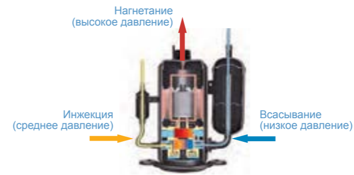
Двухступенчатый DC-инверторный компрессор
