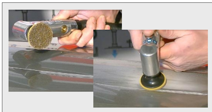
Fot.3. SZLIFIERKA PRECYZYJNA do usuwania powłok lakierowych i antykorozyjnych w miejscu naprawy. (EZ DENT)
