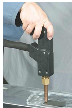
Fot. Zgrzewanie jednostronne - monopoint. (GYS)
