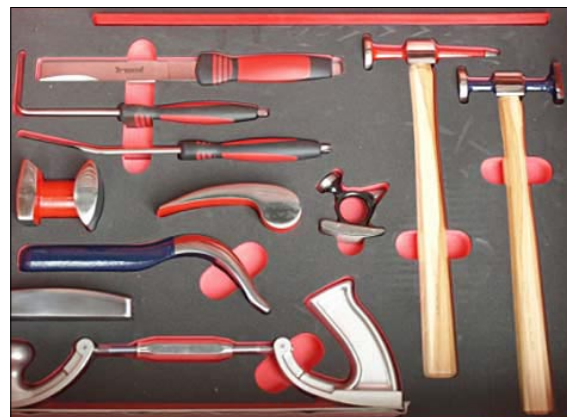
fot. 1 Zestaw narzędzi podstawowych dla blacharza umieszczonych w szufladzie wózka narzędziowego. Koncepcję „szuflady blacharskiej” opracowano w firmie HERKULES, EZ DENT oraz TRIUMF.(HERKULES)
