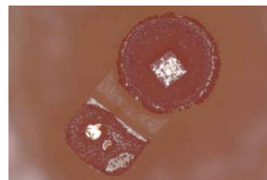
Рис. 8. Разрушение контактной площадки и крепления кристалла
