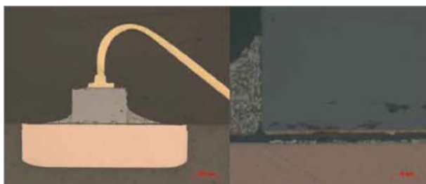
Рис. 7. На микросрезе видно отделение кристалла от подложки (справа в увеличенном виде)
