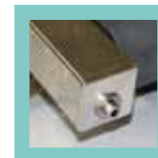
регулятор натяжения ленты tension adjustment screw
