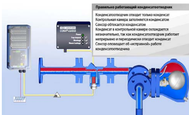
Рис.7: правильно работающий конденсатоотводчик, тип ARI CONA control
