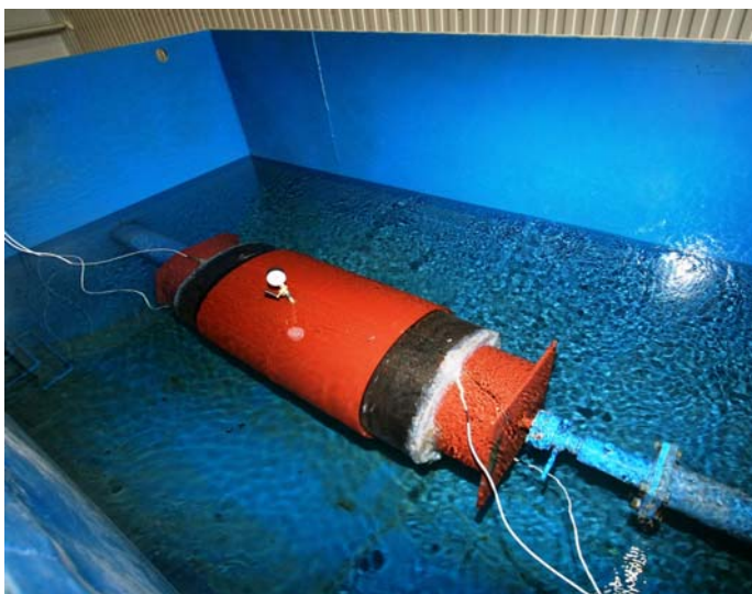
Рис. 3. Гидроиспытания компенсационного устройства
