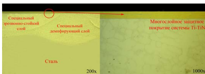
Рис. 3. Послойная структура упрочненной входной кромки лопатки
