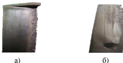
Рис. 1. Фрагменты рабочих лопаток с ленточным а) и проволочным б) бандажами с эрозионными повреждениями кромок
