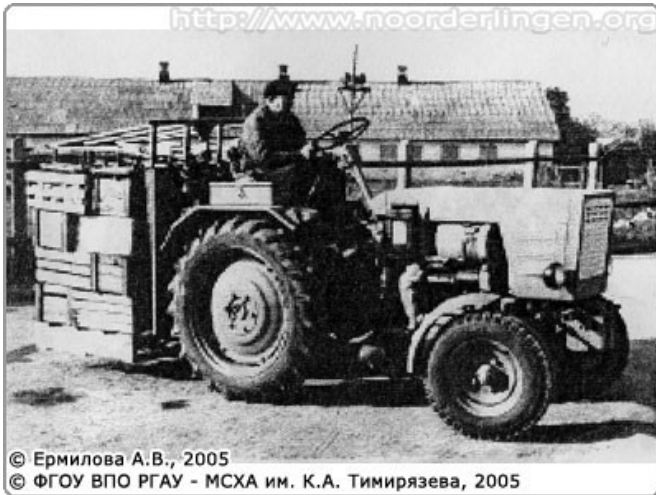
55. Плодоподъёмник в работе
