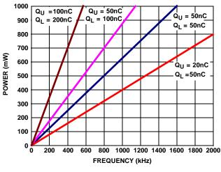
FIGURE 9. POWER DISSIPATION vs FREQUENCY
