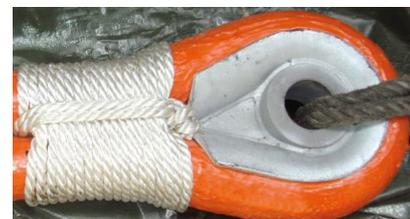
Заделка концов стропа в стальной коуш.
