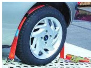
Стяжной ремень для крепления автомобиля выполнен из 100% полиэстеровой ленты шириной 50 мм с натяжным механизмом - храповиком, тремя крюками (один пришит на короткой части ремня или прикреплен к самой трещотке, второй пришит к длинной части и третий скользящий по длинной части) и 3-х уплотнительных резиновых накладок, либо резинового контроллера, предназначенных для фиксирования колес.
