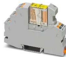
Релейный модуль с 2 переключающими контактами с принудительно управляемыми контактами, макс. 2 х 6 А
