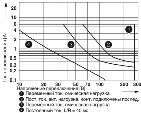
Электрическая мощность отключения для PLC...1IC/ACT для высоких пусковых токов
