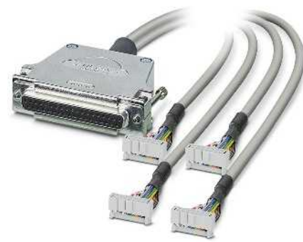
Разветвительный кабель, гнездовая планка D-SUB на гнездовой планке IDC/FLK, количество контактов: 37 на 4 x 14
