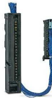
Реализация перехода с Allen Bradley PLC-5 на SIMATIC® S7-1500
