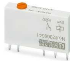
Реле с одним переключ. контактом, с ручным управлением, макс. 6 А
