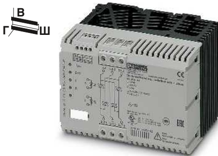
для реверсирования 3-фазных двигателей переменного тока до 575 В перем. тока/3 x 37 А
