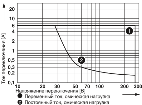
Электрическая мощность отключения для PLC...21 с реле с одним переключающим контактом
