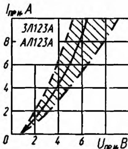
Зона возможных положений зависимости импульсного прямого тока от напряжения
