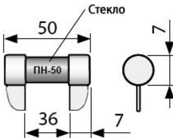
Габаритные и установочные размеры предохранителя ПН-50.
