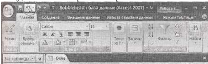
Рис. 1.12. Команда Отменить выводится на Панели быстрого доступа в верхней левой части окна программы Access (дугообразная стрелка), поэтому она всегда доступна.
