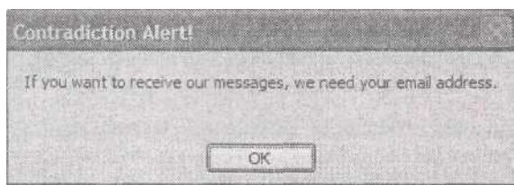
Рис. 15.22. Этот макрос состоит из двух макрокоманд с условием. Для блокировки некорректных данных присоедините его к событиям До обновления и До вставки
