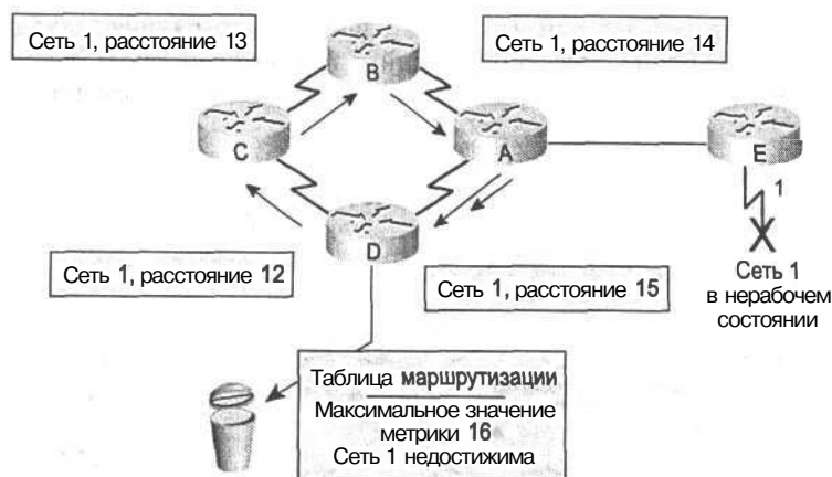
Рис. 11.20. Бесконечность можно определить в виде максимального допустимого расстояния
