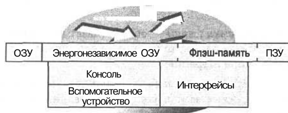
Рис. 13.2. Внутренние компоненты, участвующие в процессе маршрутизации, включают несколько элементов
