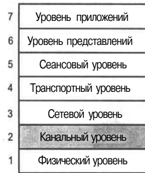
Рис. 3.3. Уровень 2 — следующий уровень модели OSI, на котором ищут неисправности
