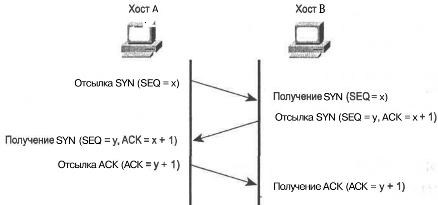
Рис. 10.7. Обмен данными невозможен до тех пор, пока не будет успешно завершено трехстороннее квитирование
