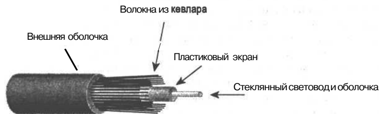
Рис. 2.6. Оптоволоконный кабель способен передавать модулированный световой сигнал
