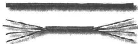
Рис. 8.2. 100-омный кабель UTP, содержащий четыре витые пары
