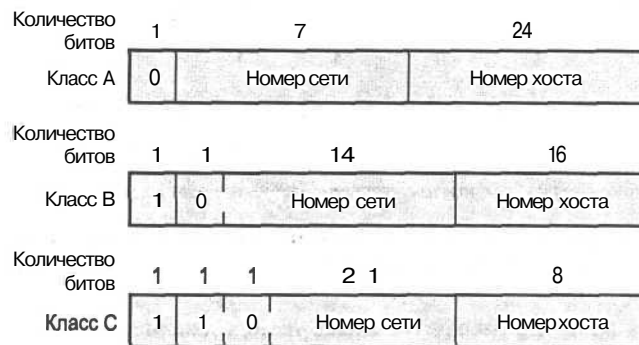
Рис. 5.10. Общий вид IP-адресов классов А, В и С
