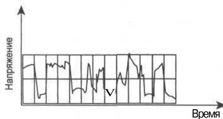
Рис. 8.16. Шум накладывается на цифровой сигнал, принимаемый компьютером
