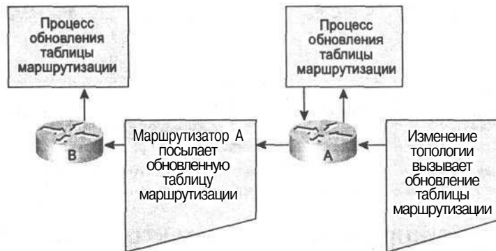
Рис. 11.17. Обновления таблиц маршрутизации происходят шаг за шагом от одного маршрутизатора к другому
