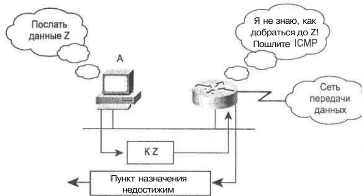
Рис. 10.16. Протокол ICMP сообщает, что требуемый пункт назначения недоступен
