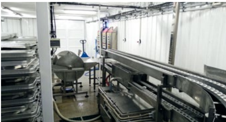
Несмотря на компактность завода, вся логистика продукта и тары здесь осуществляется по транспортерным линиям
