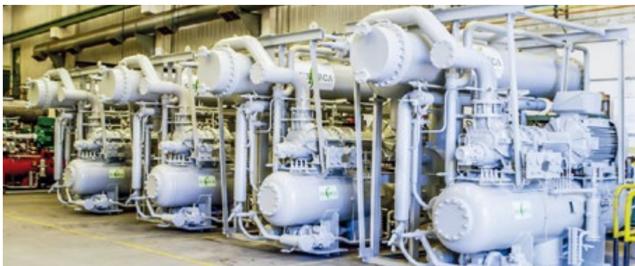
Компрессорные агрегаты KINARCA холодопроизводительностью 362 кВт (-27...+35°C) для траулера Galerna II
