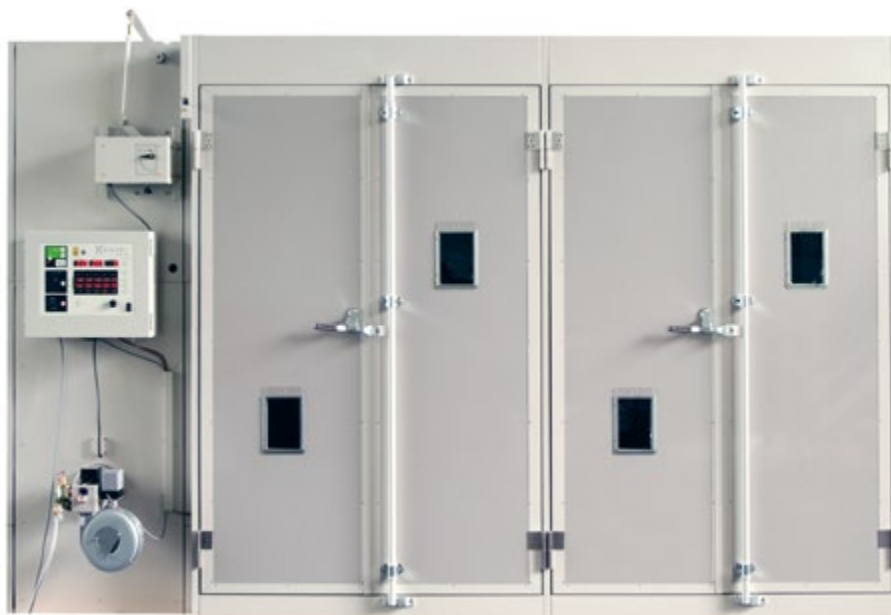
Сушильная камера для пищевого производства (KIHARA)
