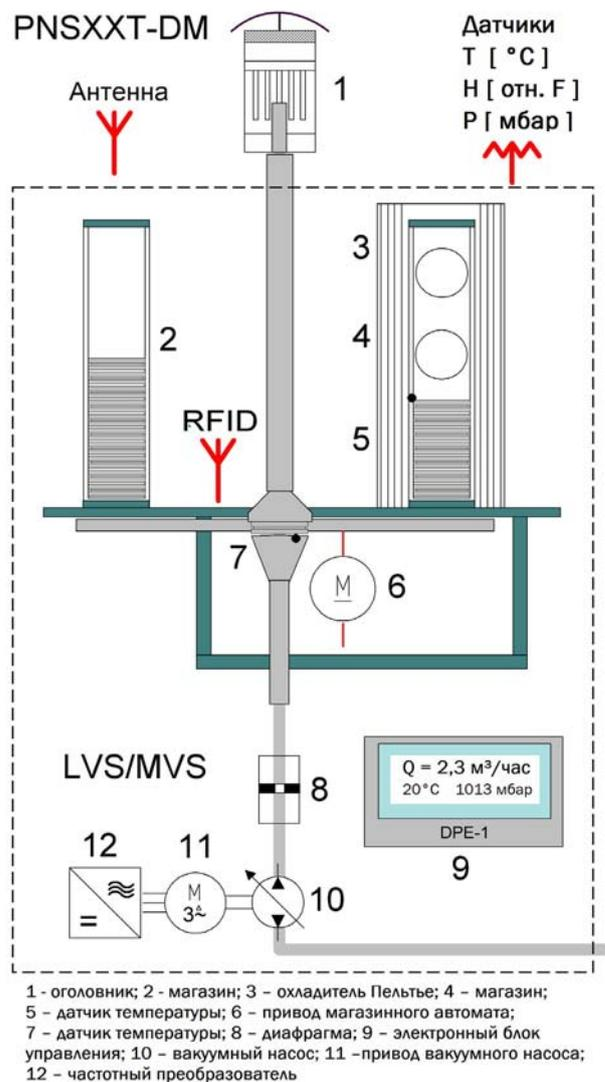
Воздухонепроницаемый монтаж оголовника реализуется на алюминиевой всасывающей трубе с внутренним диаметром 40 мм. Наружные и внутренние поверхности трубы полированы и элаксированы. В силу этого удается избежать потерь вследствие комкования частиц, например вызванного турбулентными завихрениями на внутренней поверхности трубы.
