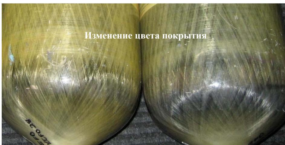
Так как обмотка на шее не присоединена к обмотке корпуса баллона, за счет различных скоростей расширения волокна, смолы и краски в точке перехода иногда возникают мелкие трещины смолы (см. рисунок ниже).
