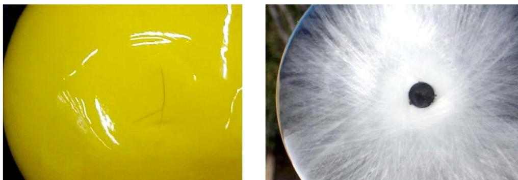
**Трещины в области этикетки** – В области этикетки, в верхнем, косметическом покрытии смолы могут появиться окружные волосяные трещины. Поскольку этикетка находится под последним слоем стекловолокна, на том месте получается слегка приподнятая поверхность. В результате, по краям этикетки иногда могут появиться поверхностные трещины смолы. Это явление на целостность или работоспособность баллона не влияет, ремонт не требуется.
