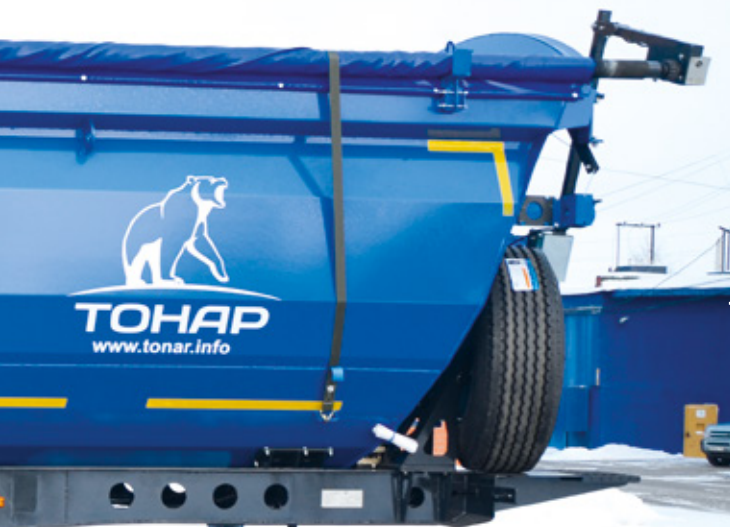
Угол опрокидывания кузова для задней разгрузки составляет 47°
