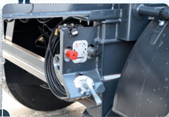
В транспортном положении тележка выдвинута для распределения массы груза и самого прицепа на оси. Для разгрузки тележку сдвигают. Общий вес автопоезда гружёного автопоезда не превысит 44 тонны.
