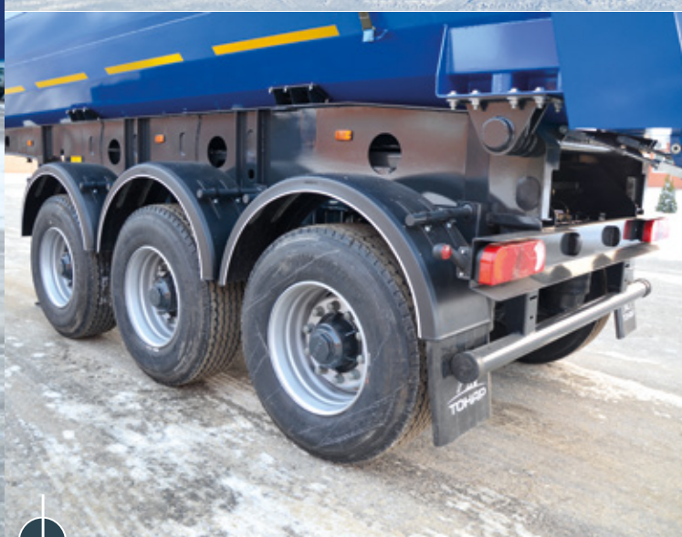
На трёх осях полуприцепа используются шины размерностью 385/65R 22,5 односкатной ошиновки. Подвеска зависимая, рычажная с пневматическими упругими элементами и телескопическими гидравлическими амортизаторами.
