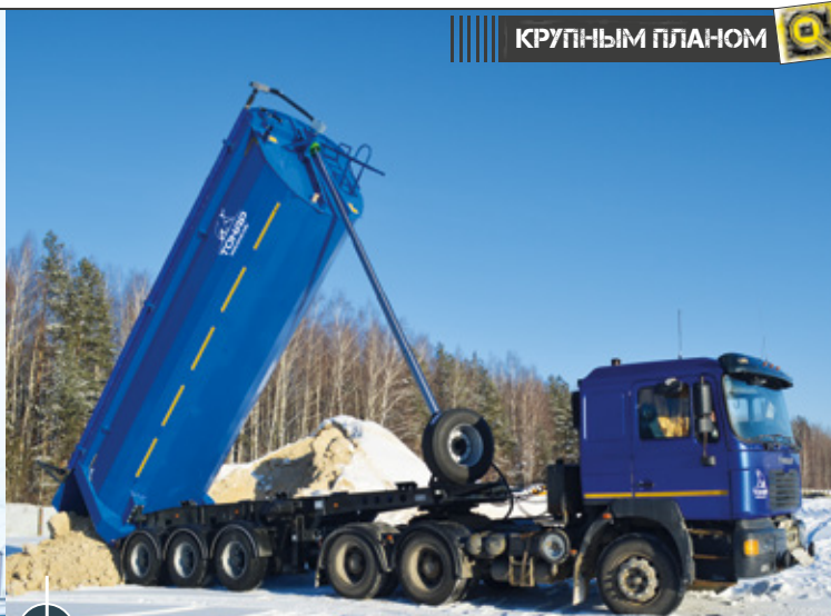
Угол опрокидывания кузова для задней разгрузки составляет 47°
