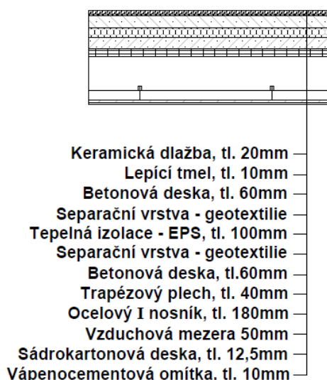
Obr. 19 – Konstrukce stropu, zdroj: vlastní
