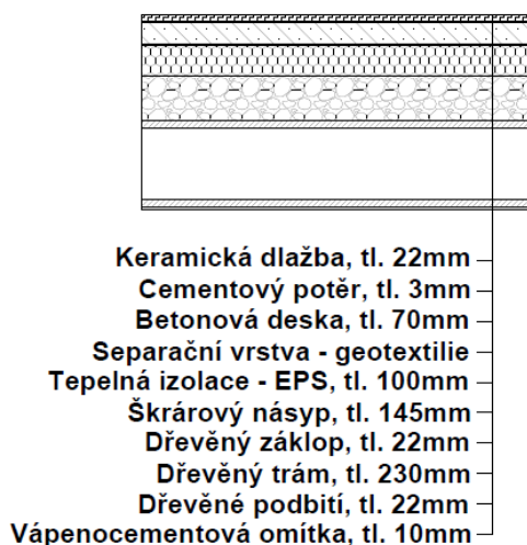
Obr. 13 - Konstrukce stropu, zdroj: vlastní
