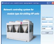
Программа позволяет осуществлять управление, диагностику несколькими (До 16) группами модульных чиллеров с использованием персонального компьютера, подключенного к сети.
