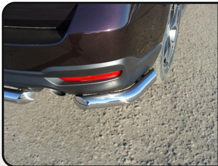
**Защита задняя (уголки длинные) 60,3 мм**
