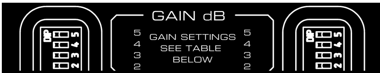
Рис.4: Микропереключатели уровня усиления для левого и правого каналов.
