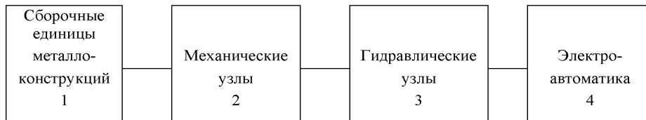
Рис. 7.7. Структурная схема надежности изделия
