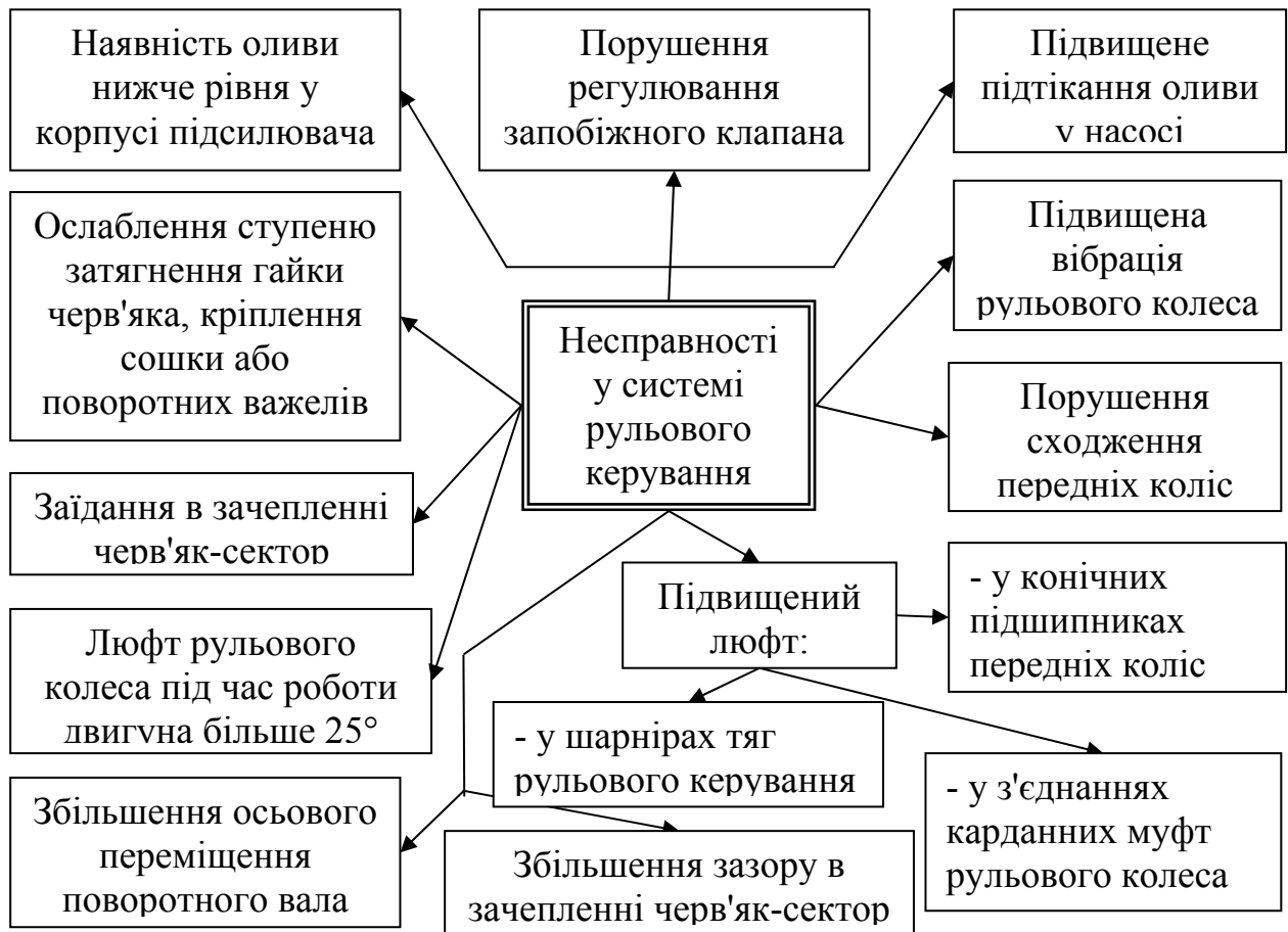
Рис. 2. Основні несправності у системі рульового керування колісних сільськогосподарських машин
