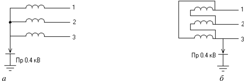
Рис. 3.9. Схемы подключения пробивного предохранителя: а - в нейтраль обмоток, соединенных в звезду; б - на фазу при соединении обмоток в треугольник
