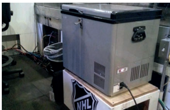
Фото 197. Специальный контейнер для шайб с температурным режимом хранения -10^{\circ}\text{C}
