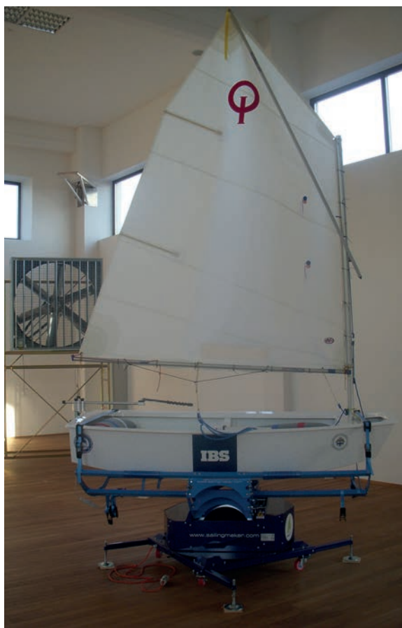
Фото 133. Симулятор ETS Elettronica srl позволяет закрепить лодку и в «сухих» условиях обеспечить тренировочный процесс
