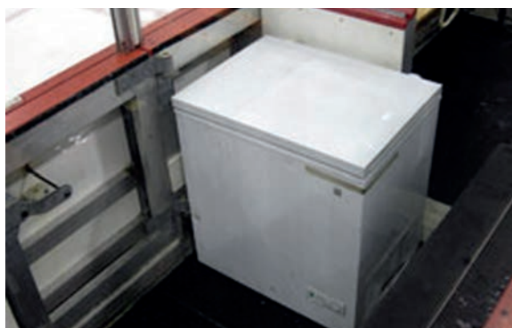
Фото 197. Специальный контейнер для шайб с температурным режимом хранения -10^{\circ}\text{C}
