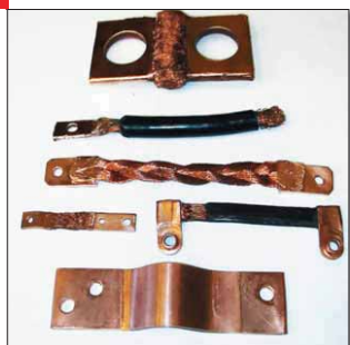
Рис. 4 Компенсаторы, изготовленные с помощью диффузионной сварки
