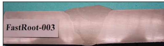
Рис. 7 Стыковой шов, V — разделка 60°, корневой проход сварен FastROOT™ в вертикальном положении. Заполнение синергетической MIG сваркой в вертикальном положении. Зазор 3–4 мм, сварочный ток 130 А, напряжение 16 В, скорость сварки 138 мм/мин, энергия дуги E = 0,9 кДж/мм и тепловложение Q = 0,72 кДж/мм
