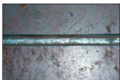
Рис. 11 Корневой проход. Угол разделки 30°, зазор 4 мм
