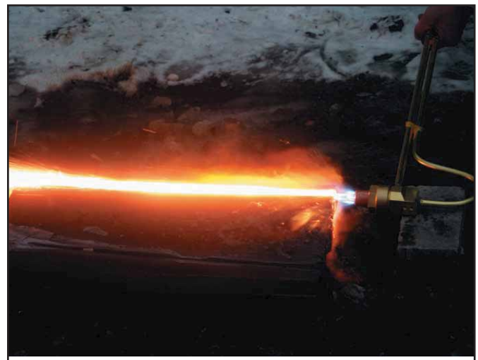
Резаки серии «НОРД» для резки сталей больших толщин (до 700 мм)
