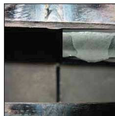
Рис. 8 Стыковое соединение без разделки, зазор 4 мм, сварка в 1 проход
