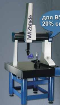
Высокоточные координатно-измерительные машины HAWK, WIZblade с лазерным сканером (2мкм)
