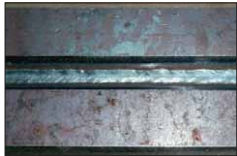
Рис. 10 Корневой проход. Угол разделки 45°, зазор 4 мм
