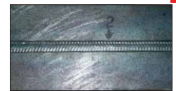
Рис. 13 Корневой шов «1» и перекрытием «2», сваренные аппаратом KemrArc на роботе Motoman
