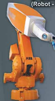
5 - осевой лазерный робот ROBOCUT (Robot - Technology, Германия)
