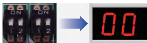
Обычная VRF-система Ручная установка адресных кодов
