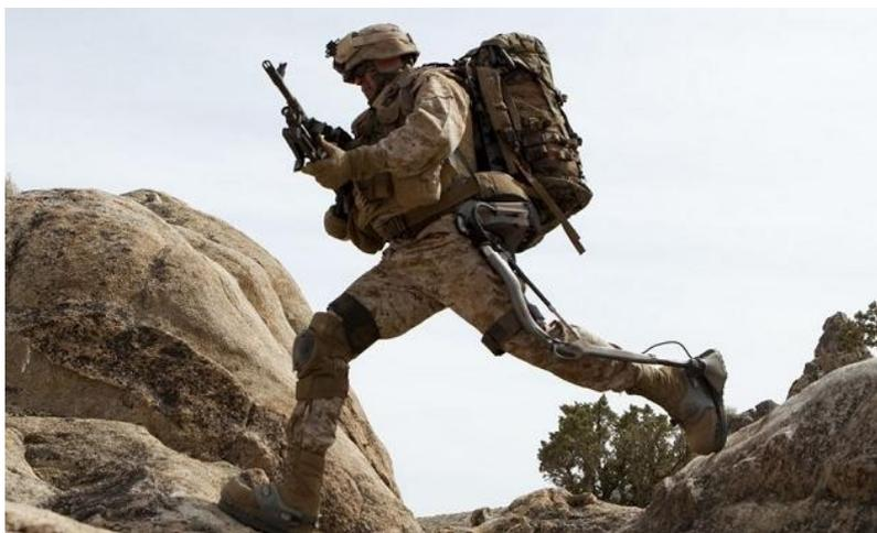
Figura 1: Esoscheletro robotico HULC per le forze armate
