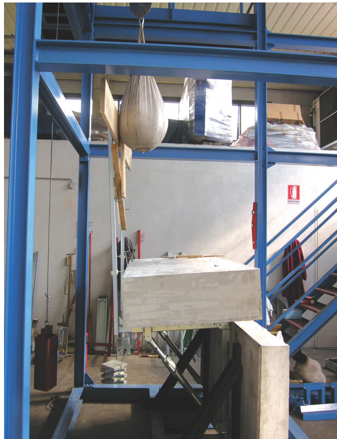
Foto delle prove statiche e dinamiche di conformità alla presenza di funzionari I.S.P.E.S.L.
