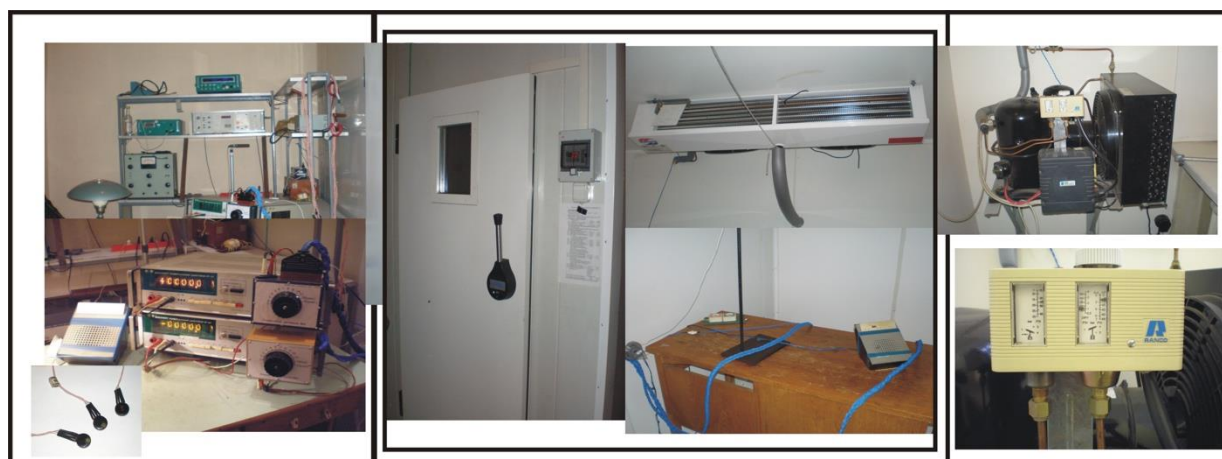
Рис. 7. Измерительный комплекс для определения температуры теплового потока с поверхности стоп при пониженной температуре
