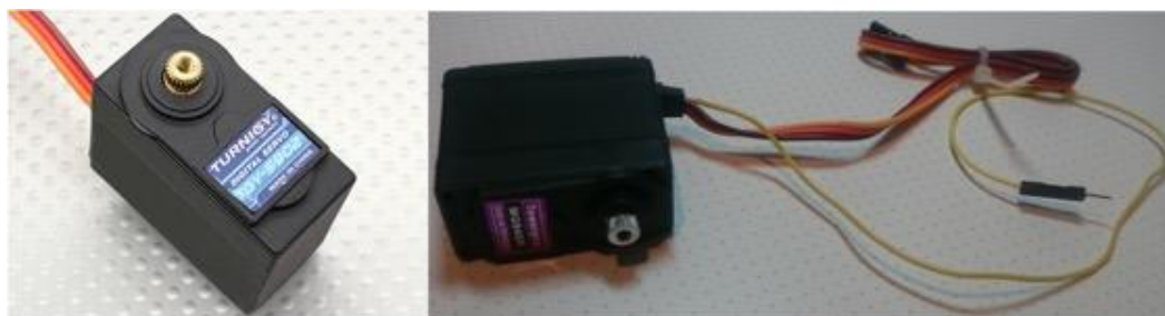
Рис. 1. Стандартный сервопривод и модифицированный сервопривод с обратной связью
