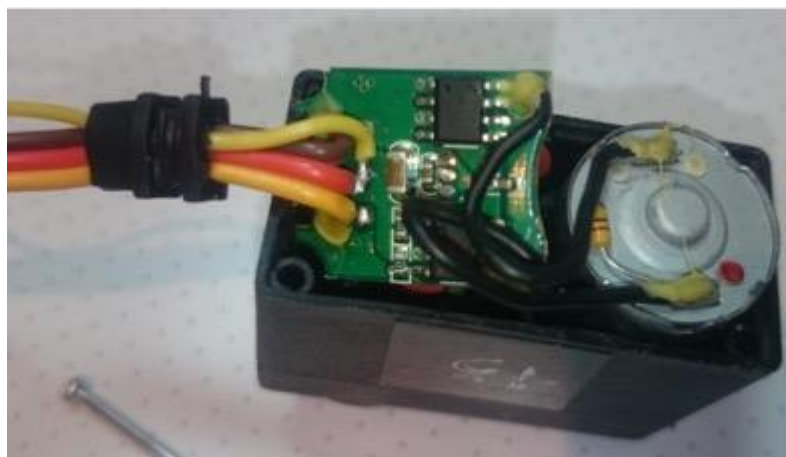
Рис. 3. Подключение к центральному контакту поворотного потенциометра для считывания выходного напряжения
