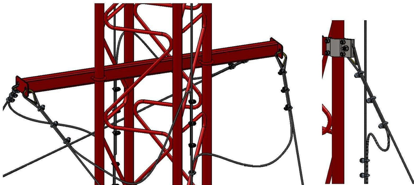
Рис. 28. Соединение оттяжек с токоотводом.
