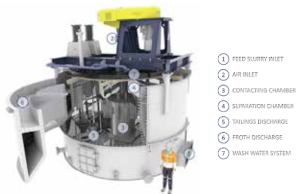
Figura 5. Diagrama esquemático de la celda StackCell®.
