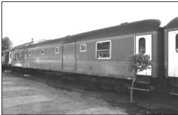
Bagagliaio tipo UIC-X per treni navetta
