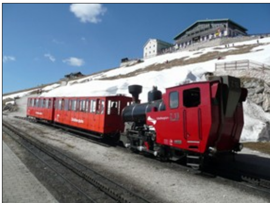
Convoglio a vapore della ferrovia a cremagliera dello Schafberg
