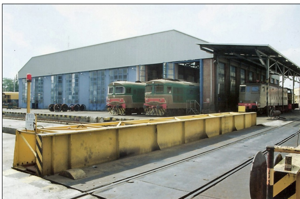
Il retro delle rimesse del deposito locomotive di Udine il 27 settembre 1992 - in primo piano il ponte trasbordatore (foto C. Canton)
