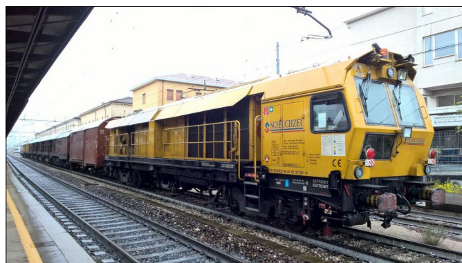
Treno Grizzly per la riprofilatura delle rotaie sul secondo binario di Udine il 29 ottobre 2019 (foto D. De Anna)
