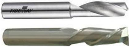
Низкий угол наклона линии зуба этих фрез специально спроектирован для обработки мягких металлов с высокой производительностью. Однозубые фрезы обеспечивают хороший отвод стружки из глубоких пазов. Обрабатывают: **Алюминий, магний, латунь, медь.**
