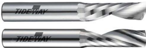
Применяются для раскроя всевозможных мягких материалов. Фрезы спроектированы специально для высоких оборотов, что обеспечивает высокую скорость обработки материала. Геометрия спиральной канавки позволяет беспрепятственно выводить стружку, это способствует хорошему охлаждению фрезы и увеличению срока ее эксплуатации.
