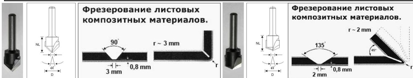
Рекомендованы для фрезерования V-образного паза (135° и 90°) на алюминиевых композитных сэндвич-панелях. Оптимальная геометрия режущих кромок и правильная заточка обеспечивают безупречное качество поверхности.
