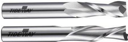
Фреза двухзаходная с удалением стружки вверх применяется для обработки с образованием более мелкой стружки и с меньшим съемом материала за один проход. Обрабатывают: алюминий, дерево, цветные металлы, текстолит, пластик ПВХ, акрил и др.
