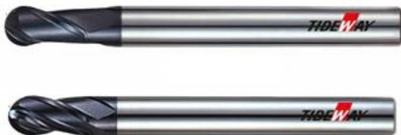
Применяются для обработки 3D моделей и U-образной гравировки. Применимы к пластикам, дереву, мягким металлам, и стали (до 45 HRC). Используются для полу-финишных и финишных обработок.
