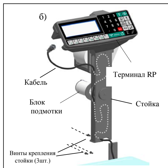
Рис. 4.3 - Сборка весов МК_RP10-1, МК_R2P10-1
