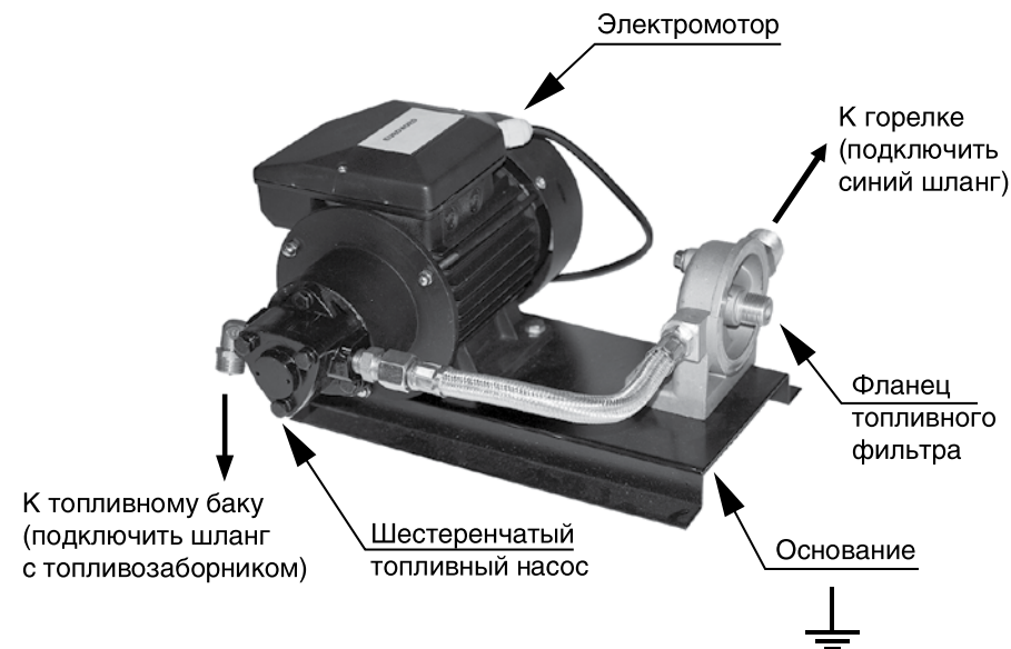
Рис. 13. Подъемный агрегат с фильтром тонкой очистки
