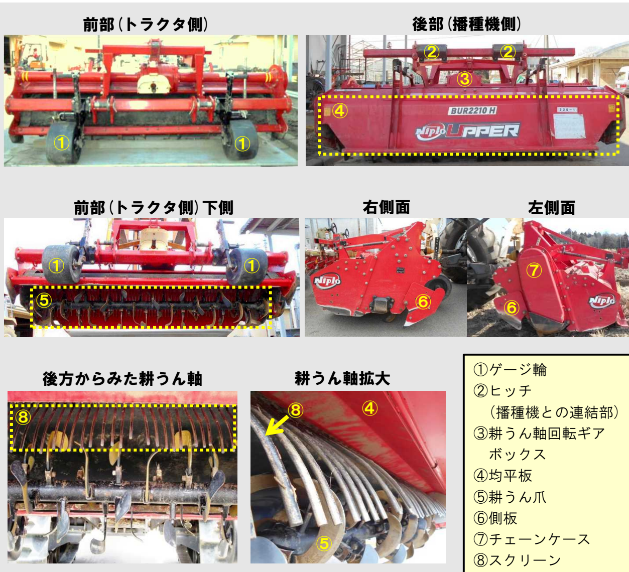
図32. アップカットロータリ (型式: BUR2210H)
