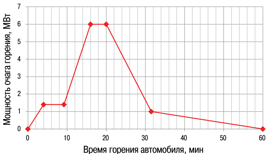
Рис. 4. График временной зависимости мощности очага горения для одного автомобиля
