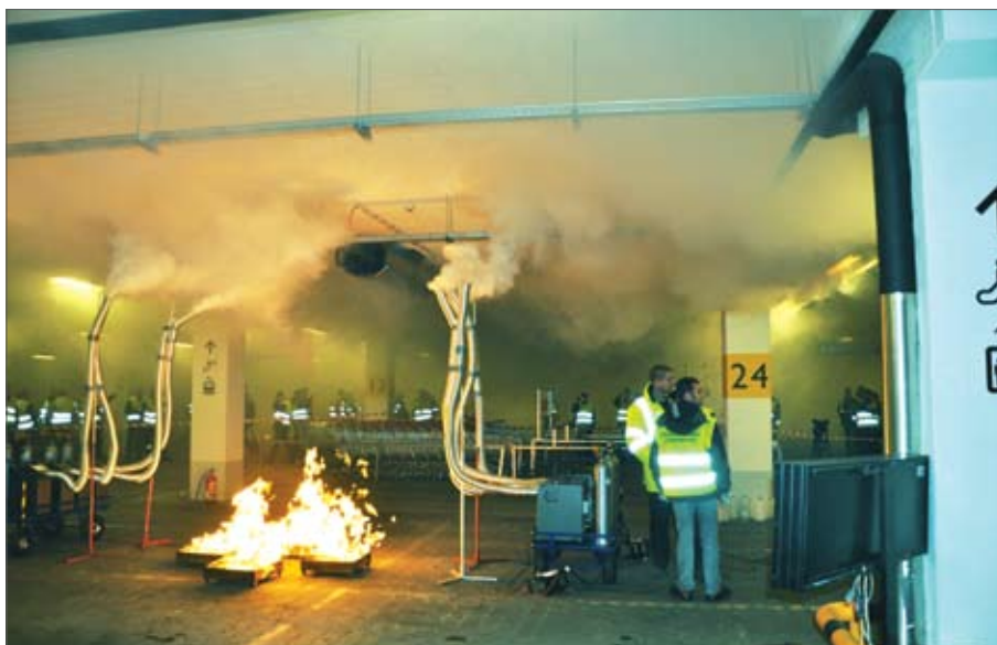
Рис. 5. Испытание противоподымной вентиляции с использованием горячего дыма
