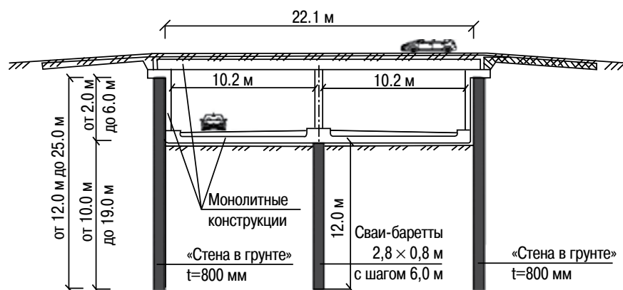
Рис. 3. Поперечный разрез тоннельной части
