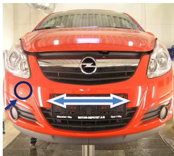
Behandling af overflader og hulrum i tværvange foran køler.
