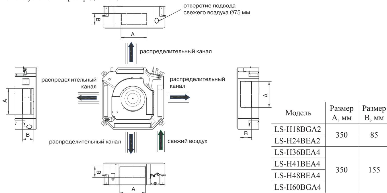
Так же возможна установка трубопровода для подмеса свежего воздуха.
