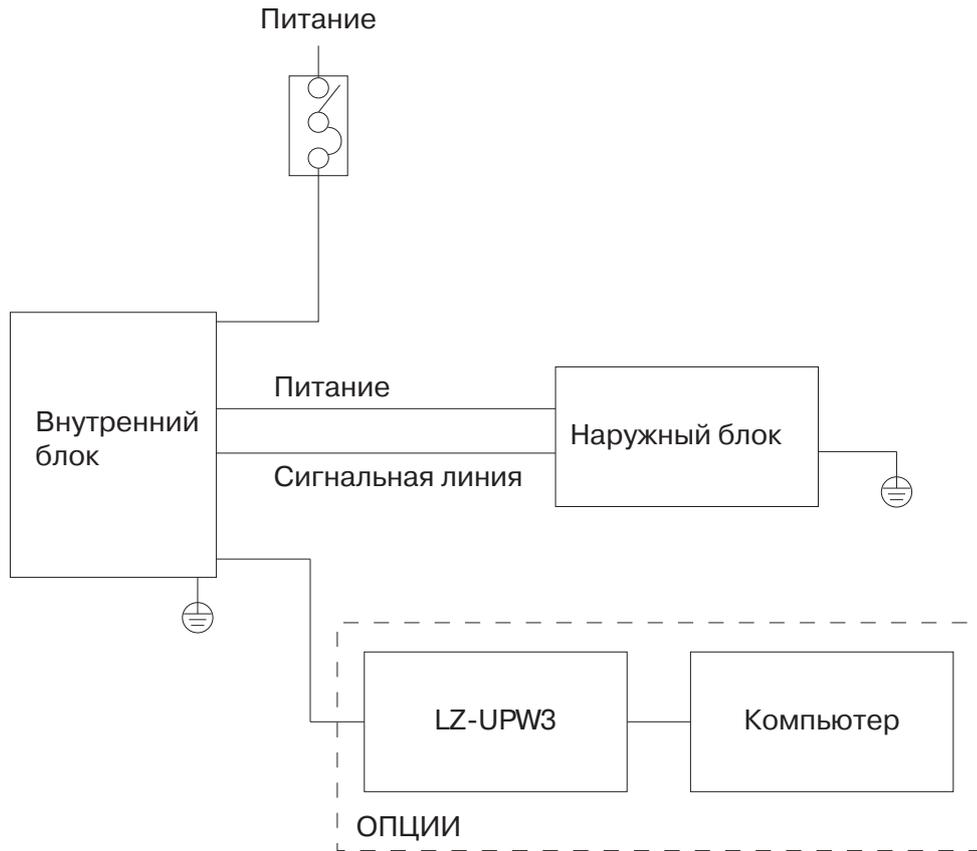
Подключение питания раздельно (отдельно внутренний блок, отдельно наружный блок)
