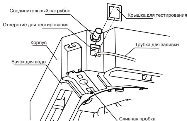
2. Включите питание и запустите кондиционер в режиме охлаждения. Прислушайтесь к звуку от дренажной трубы. Убедитесь в том, что вода сливается (учитывая длину дренажной трубы, вода может появиться с задержкой примерно на 1 минуту), проверьте герметичность соединений.
