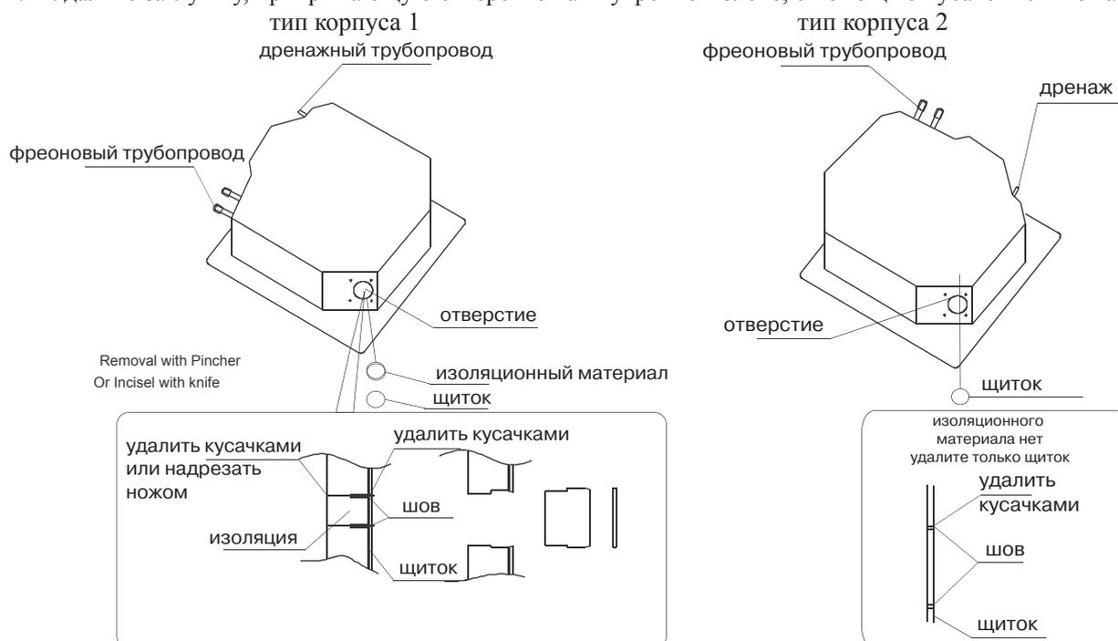
3. Установите на корпус (приклейте) изоляционный материал
