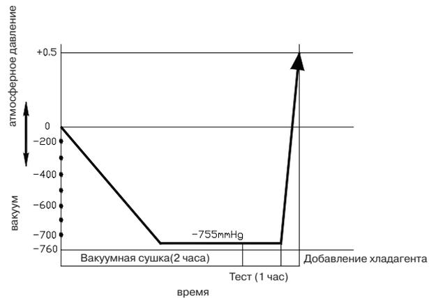
При первой установке блока на только что поставленные трубопроводы нет необходимости вакуумировать систему 2 часа, при условии, что установка трубопроводов проходила при отсутствии атмосферных осадков, и при относительной влажности воздуха не более 60%. Если установка трубопроводов проходила под осадками или при повышенной влажности, необходимо проводить вакуумирование в полном объеме.
