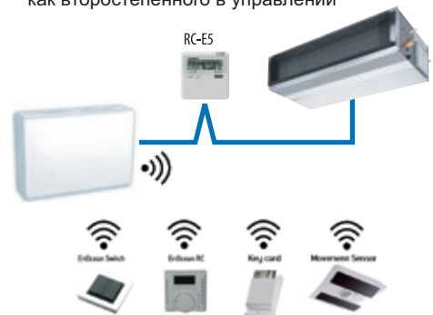
Подключение устройства как второстепенного в управлении
