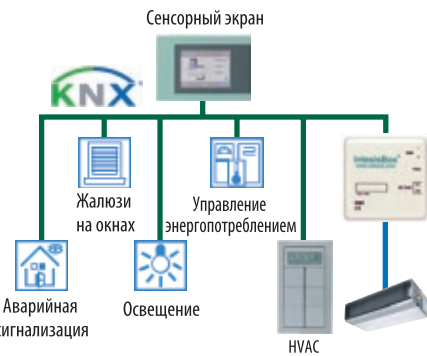
Подключение устройства как основного в управлении
