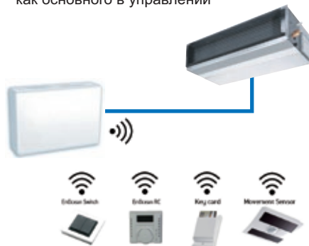
Подключение устройства как основного в управлении
