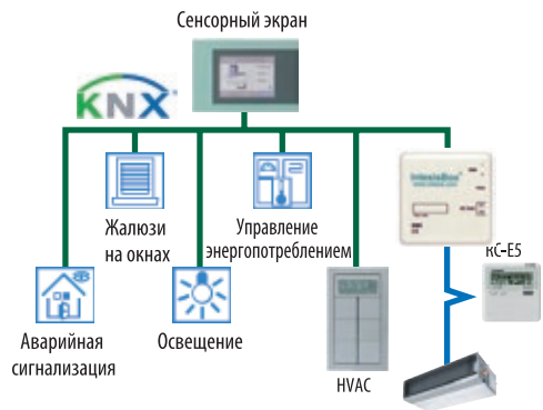
Подключение устройства как второстепенного в управлении
