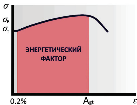
Рис. 1. Кривая растяжения арматуры
