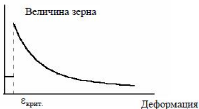
Рис. 9. Влияние степени деформации на величину рекристаллизованного зерна
