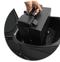
La batterie du TilScoot au lithium est amovible en quelques secondes et peut être interchangeée à volonté pour permettre de démultiplier l'autonomie. Nos batteries hautes performances (60V/32 Ah ou 60 V/40 Ah) peuvent parcourir jusqu'à 120 km. Un indicateur de charge est placé directement sur le tableau de bord permettant ainsi de ne pas tomber en panne. Les batteries sont équipées de chargeur rapide et se branchent sur des prises 220 V.
