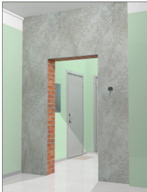
ОШТУКАТУРИВАНИЕ НАРУЖНОЙ И ВНУТРЕННЕЙ СТОРОНЫ
