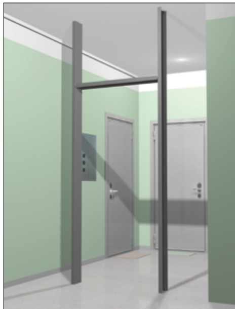
УСТАНОВКА H-ОБРАЗНОГО КАРКАСА ИЗ ШВЕЛЛЕРА
