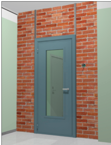
КИРПИЧНАЯ КЛАДКА В ПОЛКИРПИЧА
