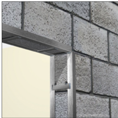
ГОРИЗОНТАЛЬНЫЕ УГОЛКИ ПРИВАРИВАЮТСЯ К ВЕРТИКАЛЬНЫМ.
