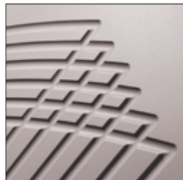
НЕГЛУБОКАЯ ФРЕЗЕРОВКА ПОЛУ- КРУГЛОЙ ФРЕЗОЙ 10x5 мм.
