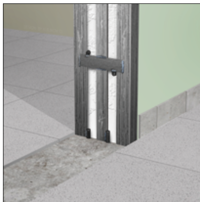
НЕСУЩИЙ ПРОФИЛЬ И УГОЛКИ УСИЛЕНИЯ ПРИВАРИВАЮТСЯ К ШТЫРЯМ ВБИТЫМИ В ПЛИТУ ПЕРЕКРЫТИЯ
